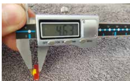
Fig. 5, 6, 7 – Măsurarea ansamblului Matrice – Patrice.
