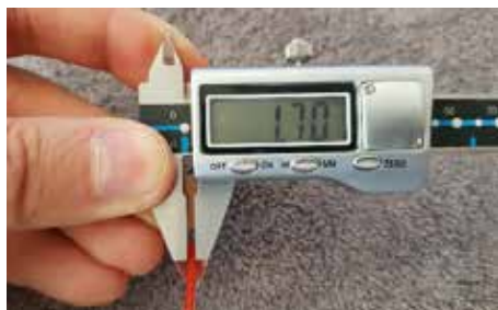
Fig. 2 – 3 Măsurarea barei cu șublerul.
