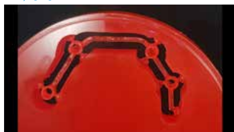
Fig. 29 Frezarea barei din PMMA-ul calcinabil de la Dentsply Sirona
