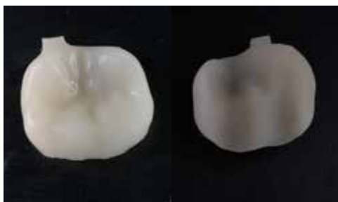
Fig.15 piesa protetică ieșită din mașina de frezat (CEREC MCXL), fața ocluzală și fața internă a piesei.
