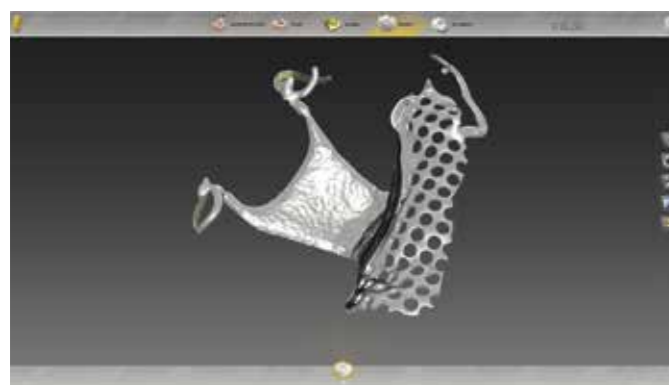
Las herramientas de diseño permiten adaptar a medida la prótesis esquelética.
