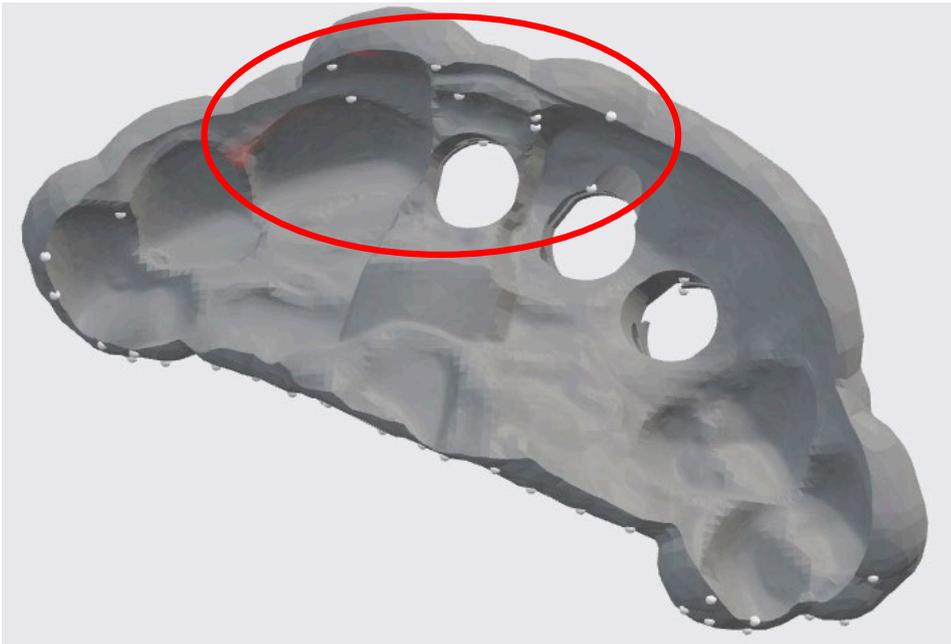
**Hinweis:** Es kann erforderlich sein, dass die Teile in einem kleineren Winkel ausgerichtet werden müssen, wenn nach dem Entfernen der Stützstrukturen für die den Patienten berührende Oberfläche keine Lösung gefunden werden kann.
