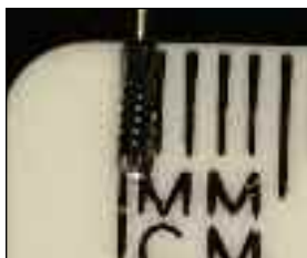
Une fraise Midwest 1558 d'un diamètre de 1,0 mm creuse sur une profondeur de 1,0 mm
