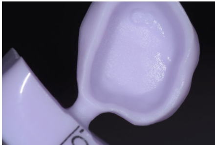
Da der Touch-Vorgang bereits zuvor abgeschlossen war, begann das Schleifen direkt nachdem die Versorgung an die CEREC Primemill geschickt worden war. Die e.max Versorgung wurde in 3:54 Minuten ohne jegliches marginales Abblättern geschliffen. Die Passform wurde überprüft, und es waren keine weiteren Korrekturen notwendig.
