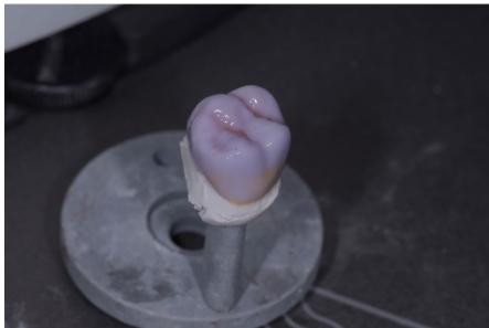
Die Versorgung wurde dann mit Ivoclar Vivadent IPS e.max CAD Crystall Shades, Stains and Glaze Paste gefärbt und glasiert.
