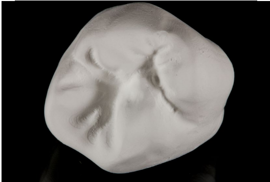
Mit dem Extra-Fein-Modus gefräste Krone direkt aus der Schleif- und Fräseinheit.
