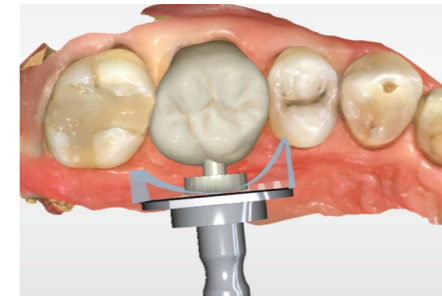
Die Fräspfade werden berechnet, und der Vorschlag wird so angezeigt, wie er später gefräst wird. Dies ist ebenfalls individualisierbar.
