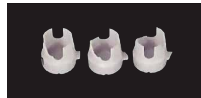
Wettbewerbsprodukt mit erheblichem Chipping im Randbereich
