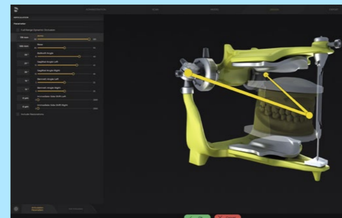
Virtueller Artikulator für die Visualisierung der kompletten Bewegungsbahnen und der Ermittlung der statischen und dynamischen Kontaktflächen für eine korrekte funktionelle Okklusion
