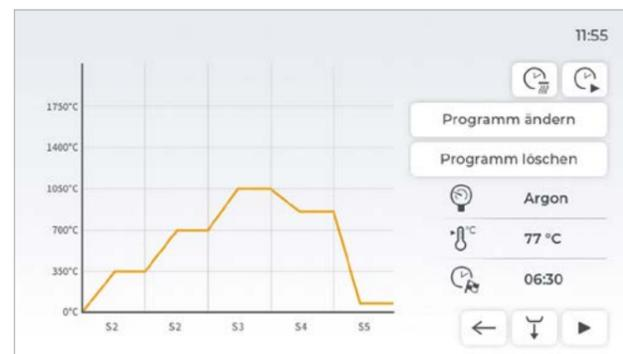
Prozessansicht mit der Möglichkeit zur Aktivierung der Vortrocknung, Anpassung von Prozessparametern, Programmierung der Auto-Start Funktionen und Anzeige der Fertigungszeit.
