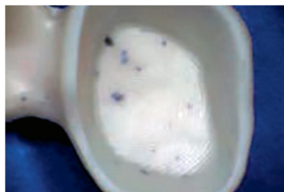
Загрязнение грязными шлифовальными инструментами
