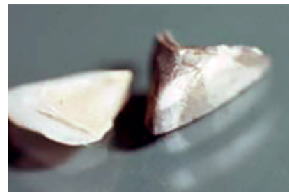
Рис. 11. Коронка VMK со сколотой керамикой
