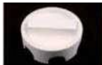
Трегер с блоком для спекания
