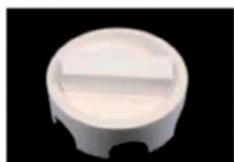
Slinovací miska se slinovacím blokem
