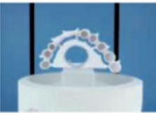
Posizionamento corretto sulla superficie di sinterizzazione
