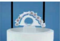
Positionnement correct sur le support de frittage
