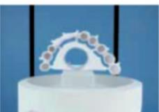
Korrekt position på sintringsbakken
