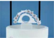
Richtige Positionierung auf der Sinterunterlage
