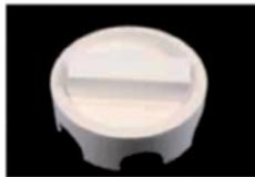
Sinterdrager met sinterblok
