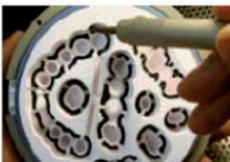
Фрезерование и извлечение объектов
