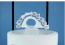
Colocación correcta sobre la base de sinterizado
