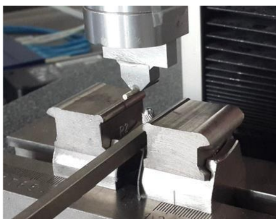
Рисунок 28 Схема трехточечного испытания с экстенсометром (Lohbauer U.)
