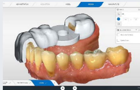
Abb. 4: Konstruktion der Bohrschablone in der CEREC SW 5.2
