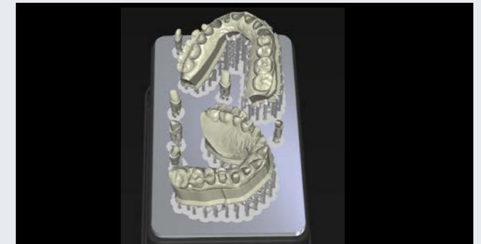
Abb. 10: Anordnung von Modellen und Stümpfen auf der Bauplattform in der inLab CAM SW 22
