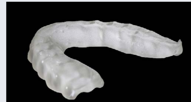
Abb. 11: Die 3D-gedruckte Schiene nach Entfernung der Stützstruktur, gereinigt und fertig zur Anprobe
