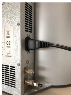
図 3- 電源プラグの正しい差込状態
