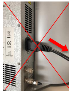
図 4- 電源プラグの誤った差込状態
