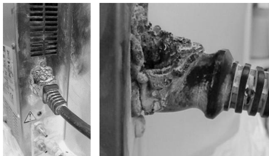
図 2- 溶解した電源プラグ
