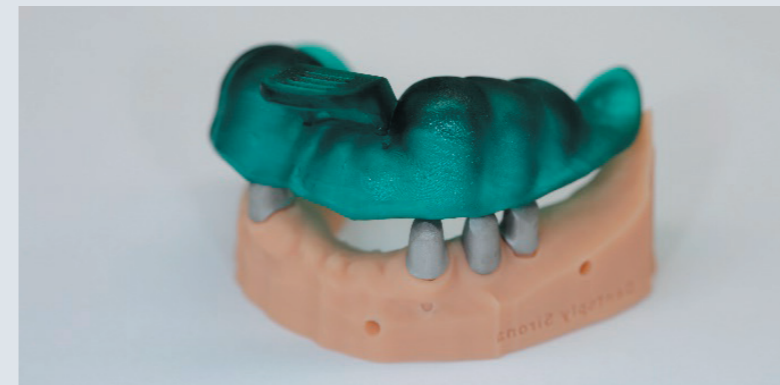
Anwendung: Fertig ausgearbeiteter 3D-gedruckter Abformlöffel auf dem 3D-gedruckten Modell aus Primeprint Tray Material und Primeprint Model Material
