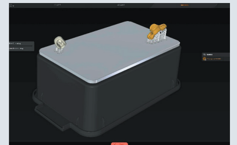
Abb. 15: Vorbereitung des 3D-Druckes für den Übertragungsschlüssel und einer provisorischen Krone (Kopie der def. Krone aus Abb. 13) in inLab CAM 22
