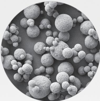
Imagem SEM das cargas pré-polymerizadas esféricas SphereTEC®. Sua forma e distribuição de tamanho otimizam o manuseio do fluxo sob demanda do material.
